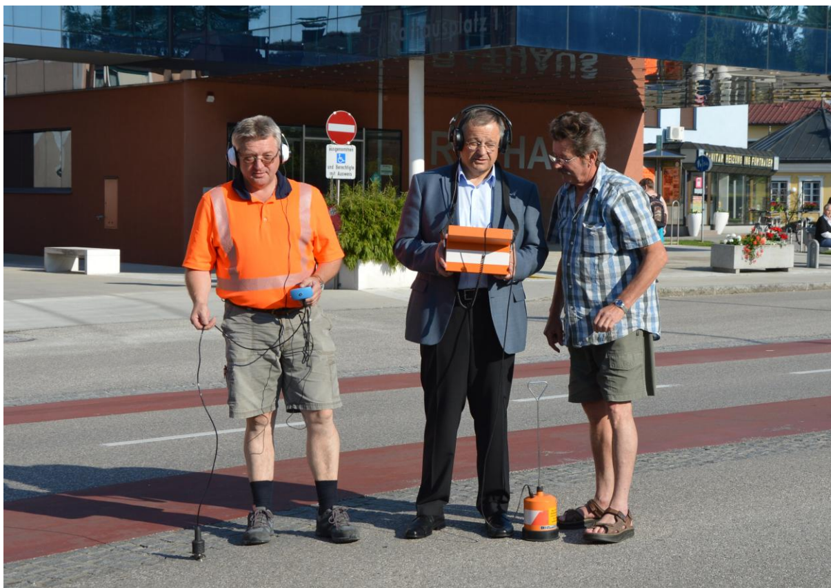
Bild v.l.n.r.: Wassermeister Christian Würflinger, Bürgermeister OStR Mag. Anton Holzleithner und Wassermeister Josef Spitzbart. Mit den Hörgeräten können undichte Stellen im Wasserleitungsnetz lokalisiert werden.
